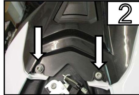
Entfernen Sie die beiden Schrauben /
