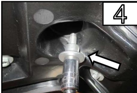
Entfernen Sie die Schraube /
