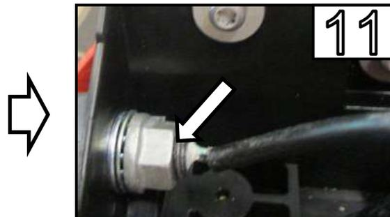
Lösen Sie die Mutter beider Blinker und
