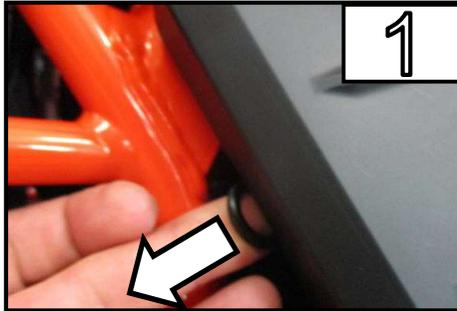
Entriegeln Sie die Sitzbank durch ziehen am Gummiband und entfernen Sie die Sitzbank /
