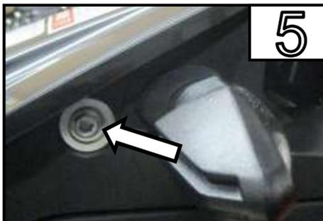
Entfernen Sie die Schraube /
