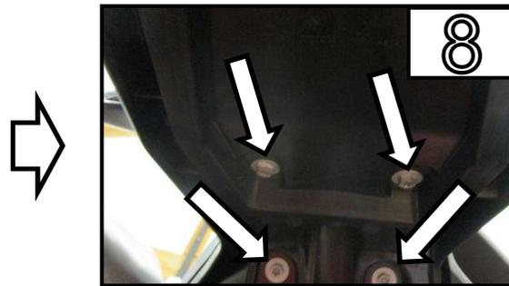
Entfernen Sie Alle 4 Schrauben und
