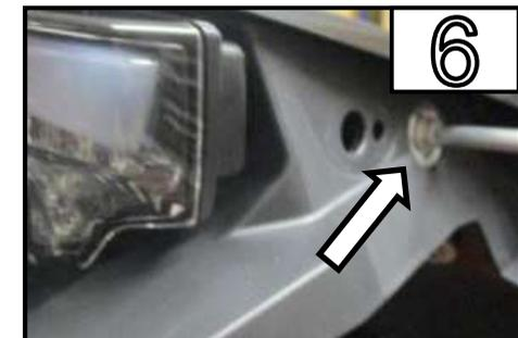
Entfernen Sie die Schraube /
