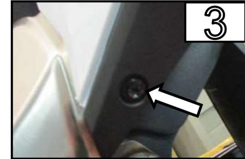
Entfernen Sie die Schraube /
