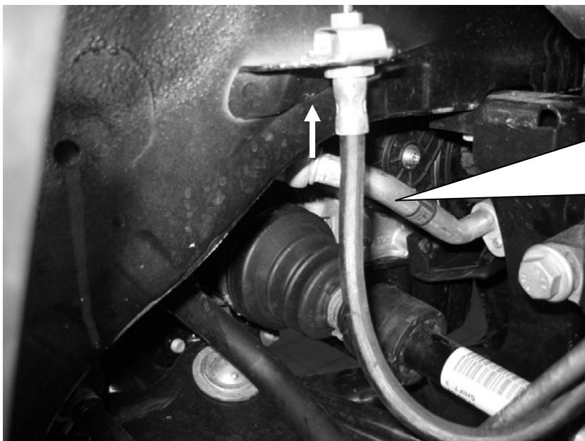
Für die Freigängigkeit der Antriebswelle muss die Klimaleitung vorsichtig um ca. 20 mm nach oben verbogen werden. Evtl. muss der Halter der Klimaleitung demontiert werden.
