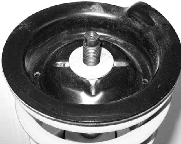
Original Stützlager aufstecken und mit der mitgelieferten Stoppmutter verschrauben. Das Anzugsdrehmoment der Kolbenstangenbefestigung beträgt 50 Nm. Die Montagehinweise zum Einbau des Federbeines in das Fahrzeug, sowie die Anzugsdrehmomente der Federbeinbefestigung, entnehmen Sie bitte den Unterlagen des Fahrzeugherstellers.
