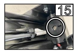
Entfernen Sie die letzte Schraube des Kennzeichenträgers / Remove the last bolt from the license plate bracket
