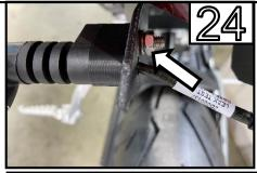
Befestigen Sie nun den Träger mit den vorderen Schrauben (Muttereinhalten, Bild 10-12 & Hülse C unterlegen)
