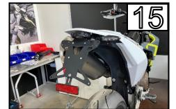
Montieren Sie den Halter für das Nummernschild an den Adaptern mit den beigelegten M8 Schrauben /
