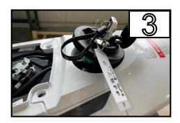
Entriegeln Sie die Sitzbank durch ziehen am Gummiband unter der Verkleidung (linke Seite am Motorrad) /
