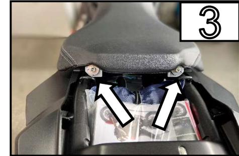
Entfernen Sie die beiden Schrauben /
