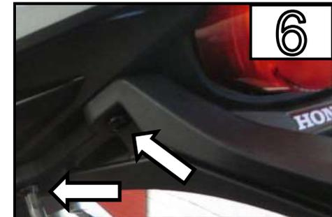
Entfernen Sie die beiden Schrauben und
