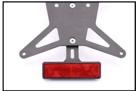
Montieren sie den beigelegten Reflektor am MG Biketec Kennzeichenträger / Assemble the included reflector onto the MG Biketec tail-tidy
