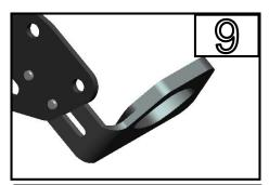
Entfernen Sie die beiden Schrauben und teilen Sie den Kennzeichenträger / Remove both bolts and split the license plate bracket Entfernen Sie die beiden Blinker vom Kennzeichenträger /
