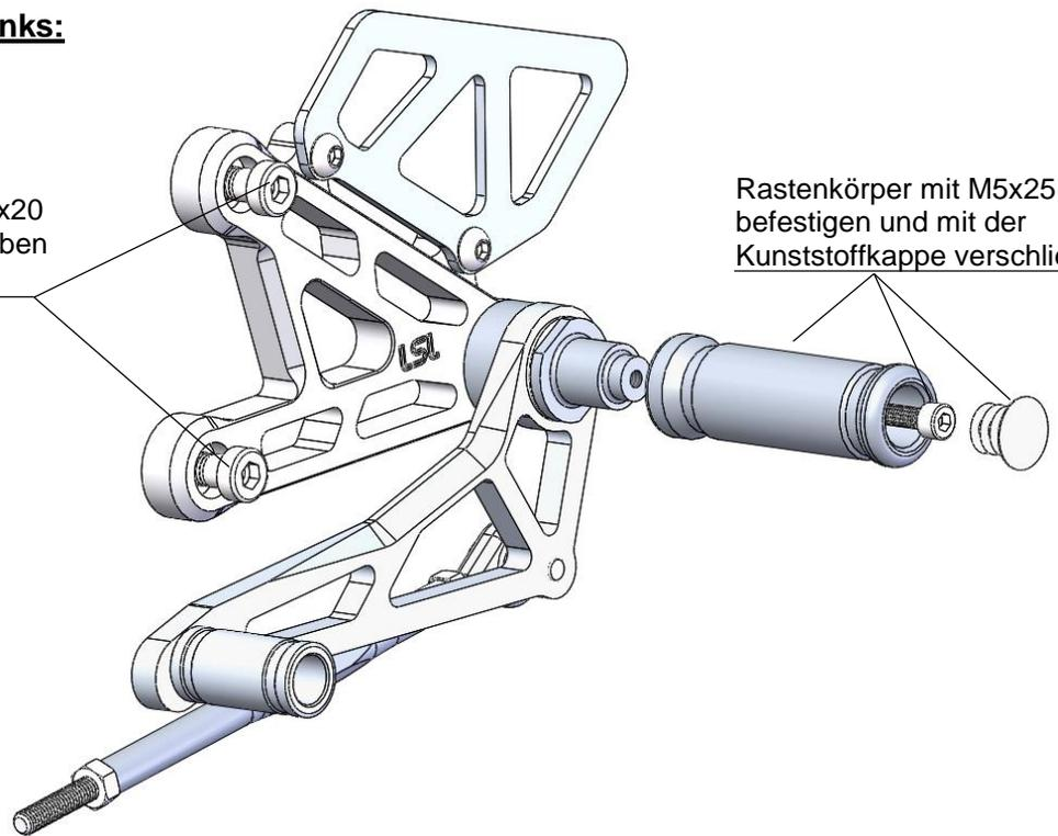
Rastkörper mit M5x25 befestigen und mit der Kunststoffkappe verschließen.
