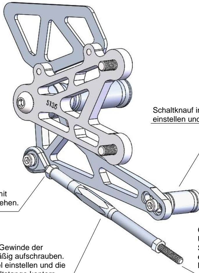
Uniballgelenk (Linksgewinde) mit M6 Mutter (Linksgewinde) versehen.
