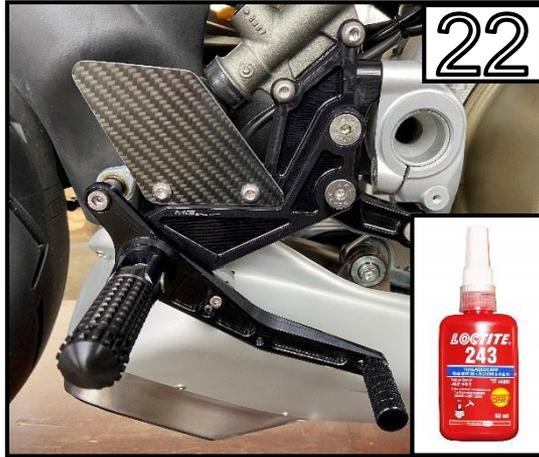
Schrauben mit Schraubensicherung (z.B.: Loctite 243) /
