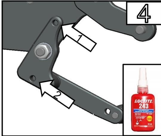
Befestigen Sie die zuvor abmontierte Schaltstange am Schalthebel Drehstück (Bauteil 4). Auf Position 1 schalten sie ganz normal und auf Position 2 ist die Umkehrschaltung. Schrauben einkleben (zb: Loctite 243) /
