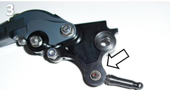
Originale Kolbenstange und Buchse in Hebel verbauen und dabei etwas Schmierfett verwenden
