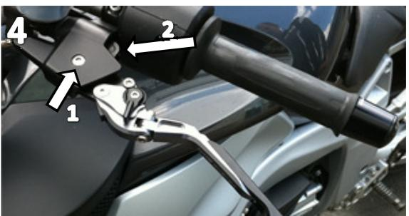
Bauen Sie den Hebel mit der originalen Hülse, Originalschraube und -mutter wieder an. Ziehen Sie die Mutter mit einem Drehmoment von 4,5 Nm fest (Bild 4-1).
