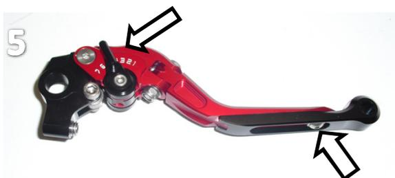
Der Hebel ist durch Drehen des Verstellhebels in 7 Positionen im Abstand einstellbar.
