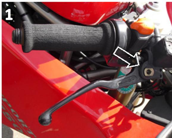
Entfernen Sie die originale Befestigungsschraube indem Sie die Mutter an der Unterseite abdrehen und anschließend die Schraube herausdrehen (Bild 1)
