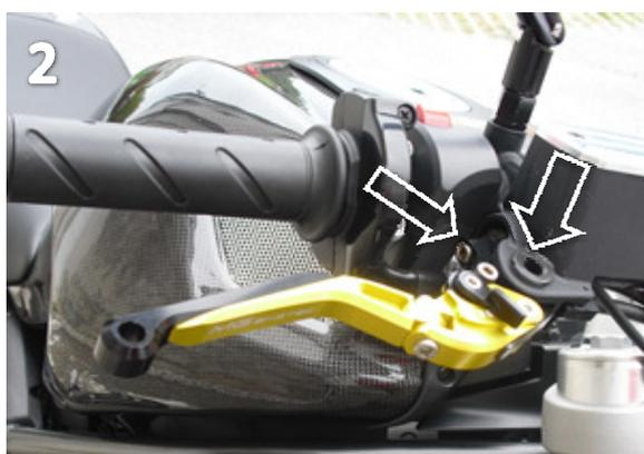
Bauen Sie den Hebel mit der Originalschraube und -mutter wieder an. Ziehen Sie die Mutter mit einem Drehmoment von 4 Nm fest (Bild 2).
