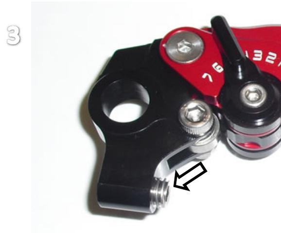
Nach der Einstellung ist die Einstellschraube mit Schraubensicherung (z.B. Loctite 270) zu sichern!!! (Bild 3)
