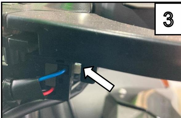
Nehmen Sie nun den Hebel von der Armatur ab indem Sie das Kupplungsseil aushängen.
