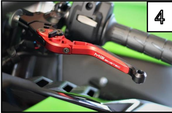
Montieren Sie den MG Biketec Hebel mit dem Originalbolzen und Mutter mit 6 Nm wieder am Motorrad. Achten Sie beim Einbau wieder auf den Mikroschalter. Stellen Sie die Vorspannung des Kupplungsseil passend ein. /
