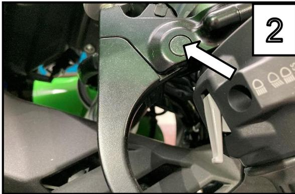
Entfernen Sie die originale Befestigungsschraube indem Sie die Mutter an der Unterseite abdrehen und anschließend den Bolzen herausdrehen./
