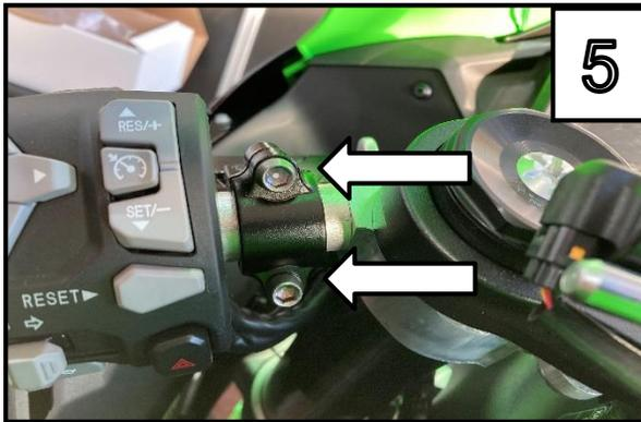
Lösen Sie eventuell beide Schrauben damit Sie die Position von MG Biketec Hebel einstellen können. Verändern Sie die Position des Hebels so, dass dieser nicht an der Verkleidung anstehen kann beim Lenkansschlag.
