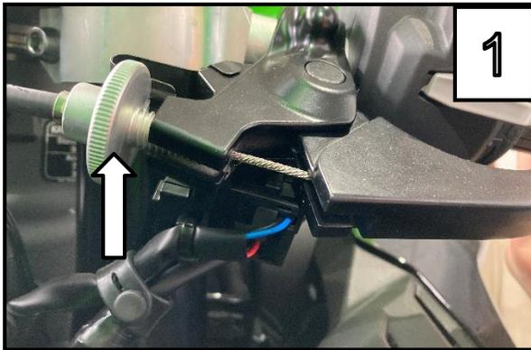
Geringern sie die Spannung am Kupplungsseil, indem Sie das gezeigte Drehrad ganz hinein drehen./
